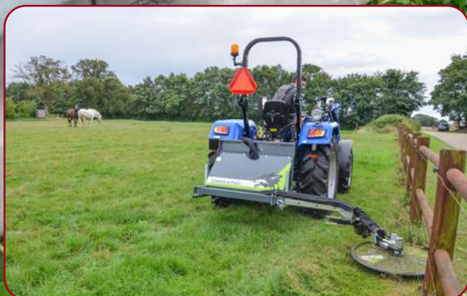
FOX monterad på traktorns 3 punkts fäste med kant- & stolpklippare RI 80
