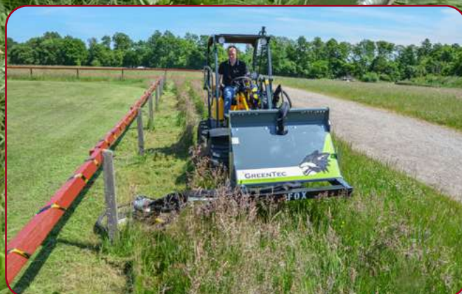
FOX monterad på lastare med kant- & stolpklippare RI 80
