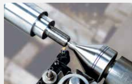
Den forlængede pinol garanterer den nødvendige frivinkel under drejning af dele med lille diameter.
