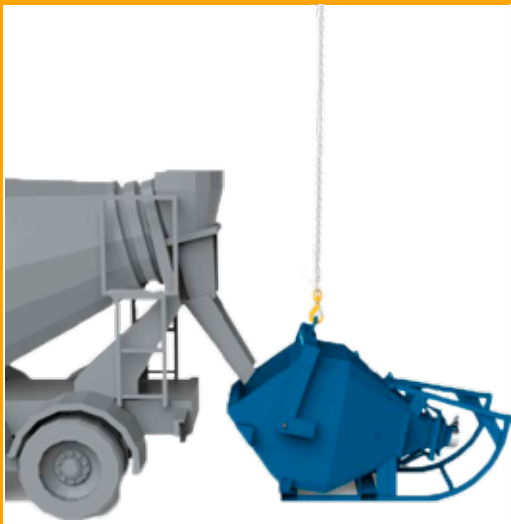
Ved påfyldning af beton
