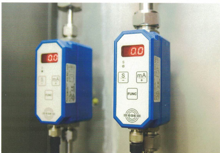
Eksempel: Inlinesensorer SDN 552 overvåger doseringen af tilsætningsstoffer
