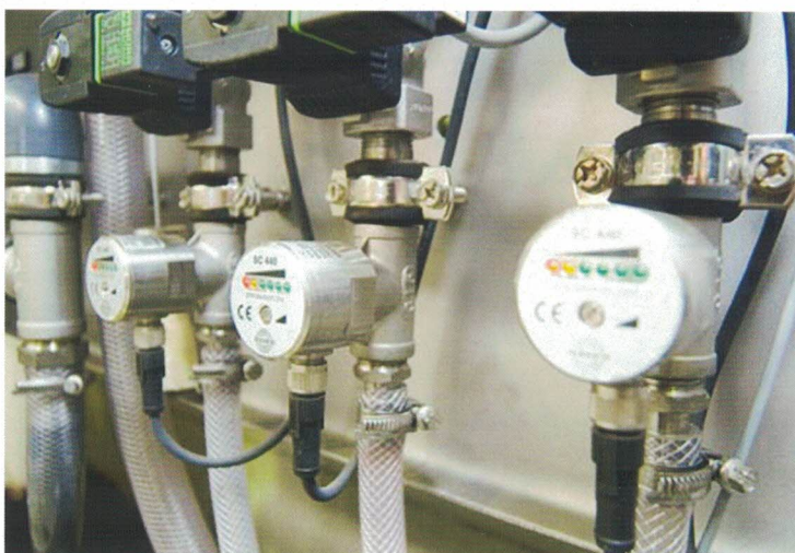
Kompakte strømningssensorer EGE type SC 440 med LED flowstatus visning overvåger en doseringsproces
