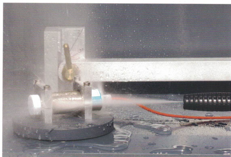
IP 68 / IP 69 højtryksrensningsresistent sensor type IGMF i test
