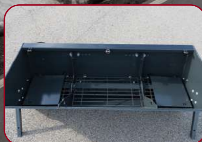
Öppningsbara skyddsgaller och spidarregleringsplåtar
