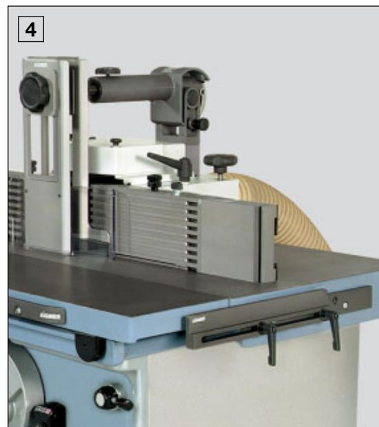
**1** Rail de fixation V rentré et fixé sur le côté gauche de la toupie.
