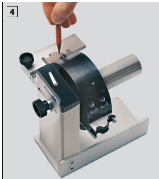
**1** Ajustage du marbre de traçage sur l'unité-lame à profiler.
