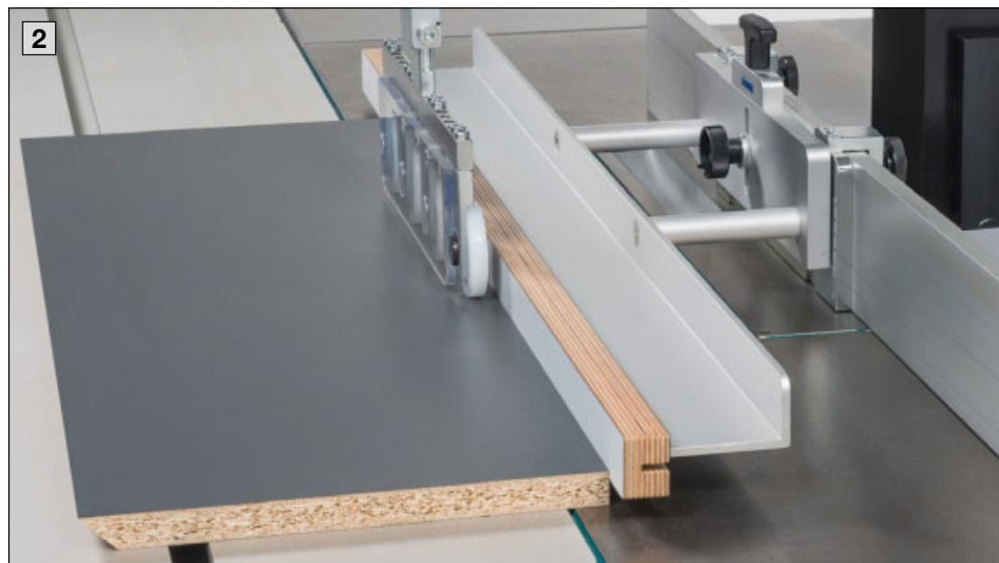
**1** Barre-Guide avec Galet de sécurité, lame de scie inclinée à l'angle voulu.
