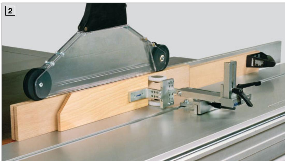
**1** Équerre de fixation avec Module-Presseur
