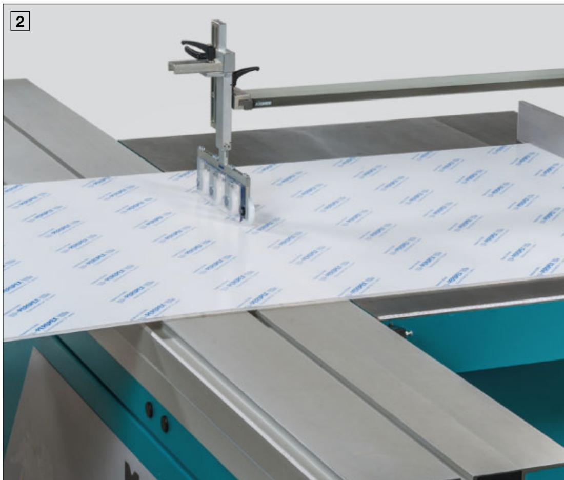
**1** Module-Presseur 1 et Galet de Sécurité assurent la pression et le guidage pour une parfaite qualité de coupe sur les panneaux.
