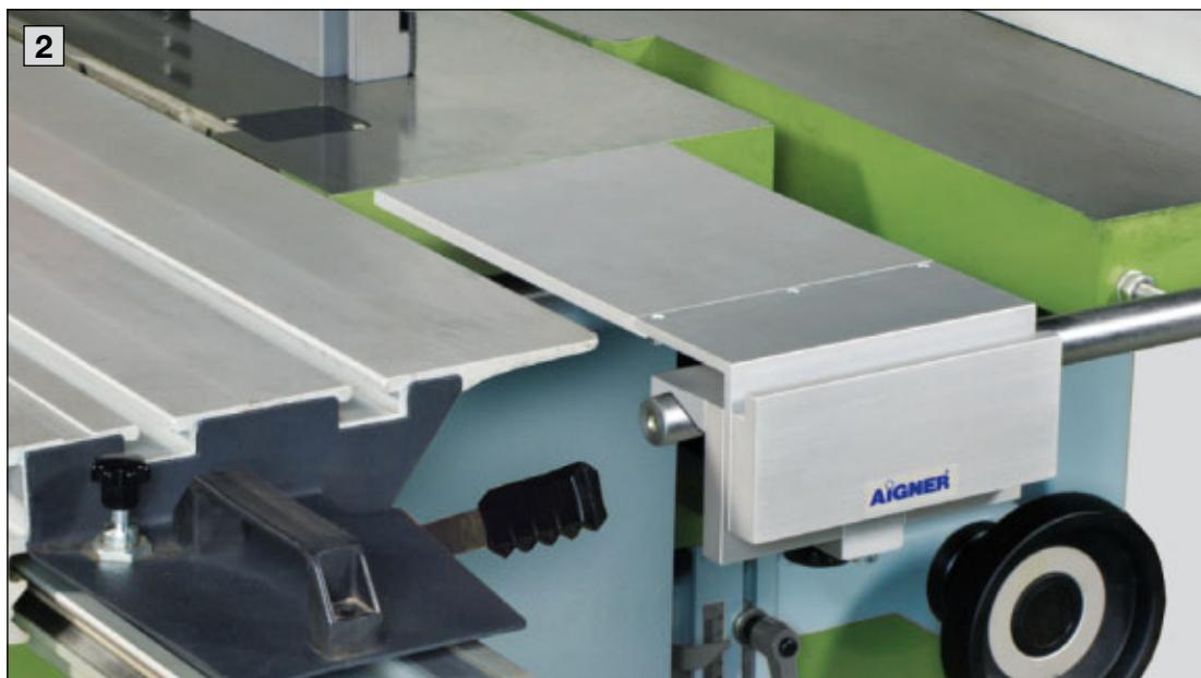
**1** Adaptateur de fixation
