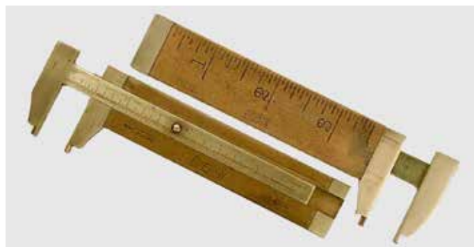
"Four foot" skydelære i buksbomtræ med messigskyder. Skydelæren kunne bruges til måling af både indvendige og udvendige rørdiametre. Et eksempel på engelsk værktøjskvalitet for skydelærene blev lavet i metal.
