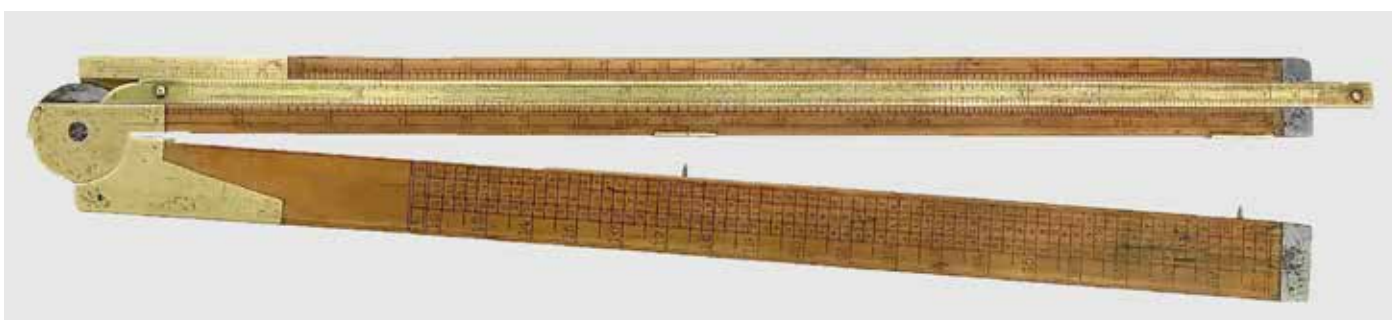
Old folding Carpenter Rule with Brass Slide fremstillet i Birmingham i midten af 1800-tallet, se beskrivelse på næste side.
