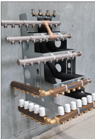
Max. bestykning af et BUNDMODUL for at det kan være i et 60 cm skab. 12 gulvvarme-, 16 koldtvands- og 9 varmtvandskredse.
