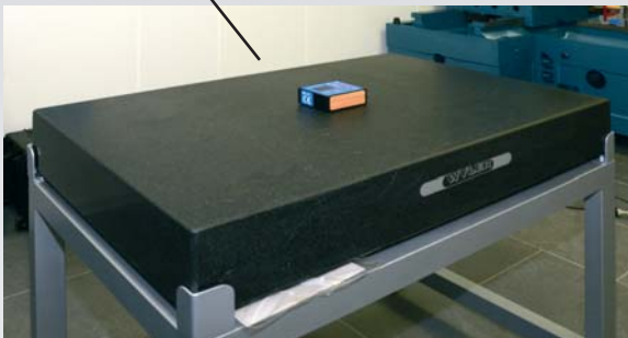
Alignment of reference surface plates of granite Ausrichten von Mess- und Kontrollplatten
