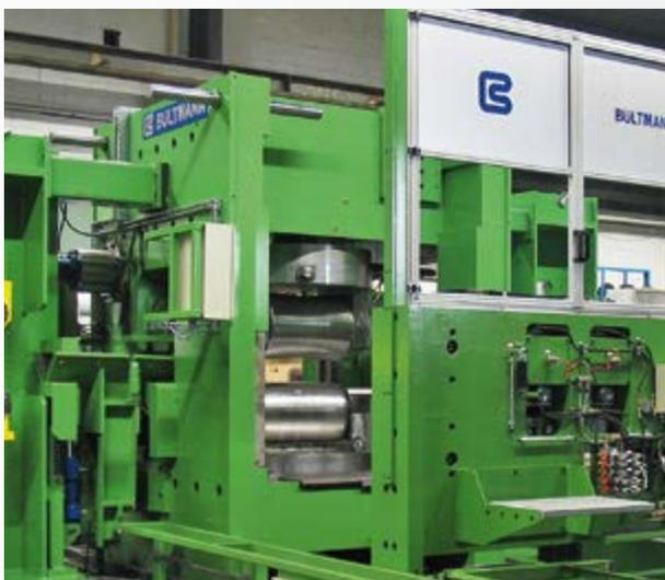
**2-Walzen-Richtmaschine für geschälte Stangen**
