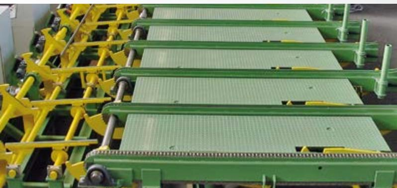
Einlauf und Auslauf einer Schälmaschine
