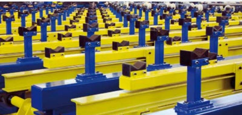
Hubbalkenquertransport einer Fasanlage für Stahlstangen
