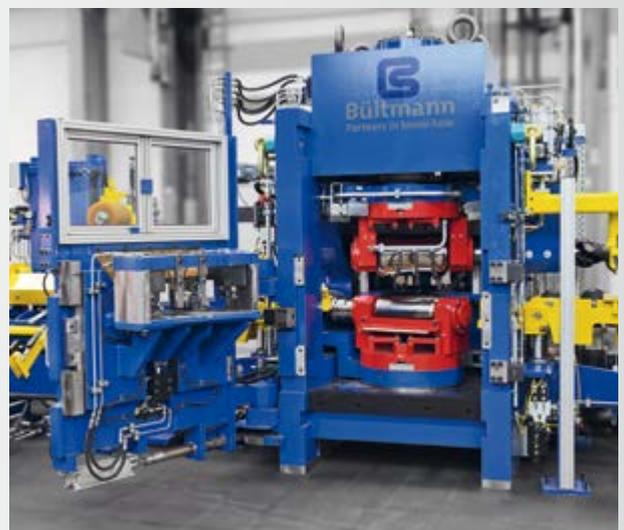
**2-Walzen-Richt- und Poliermaschine für geschälte Stangen**
