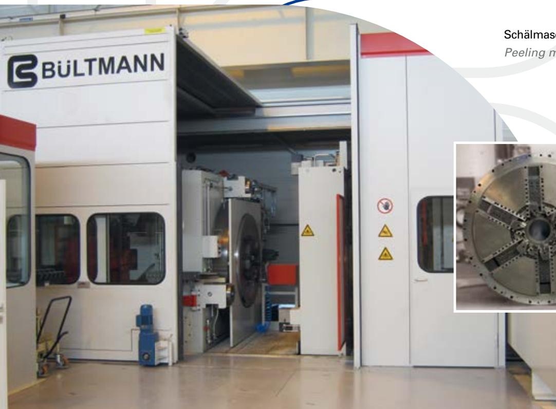
Schälmaschine für Titanstangen
