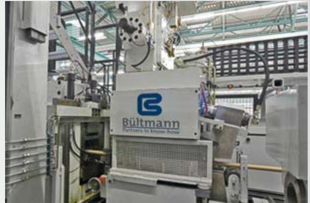
Push-Pull-Pointer in einer Ziehmaschine für Messing-
