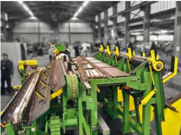
Stangenvereinzelung ab 4 mm Stangendurchmesser für geglühte Stahlstangen
