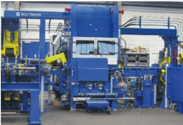
**2-Walzen-Richtmaschine für geschälte Stangen**
