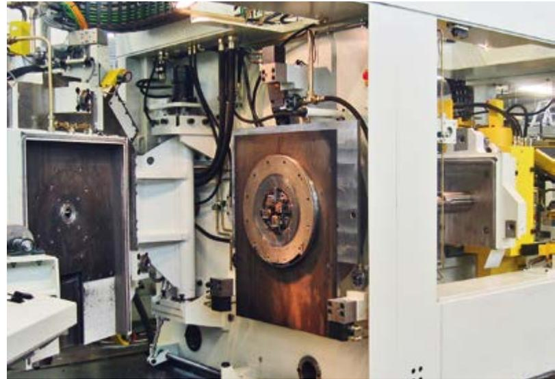
Schälmaschine für Edelstahlstangen mit geöffneter
