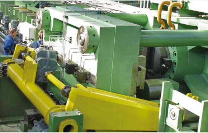
25000 kN Richtpresse für Stahlstangen
