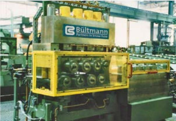
2 x 8-Rollen-Profilrichtmaschine für Messingstangen
