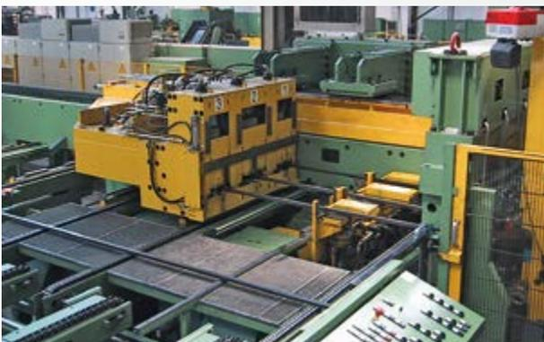
3-fach-Stangenziehanlage für Stahlstangen mit
