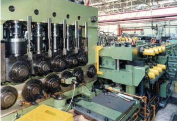
2 x 11-Rollen-Richtmaschine für Stahlstangen
