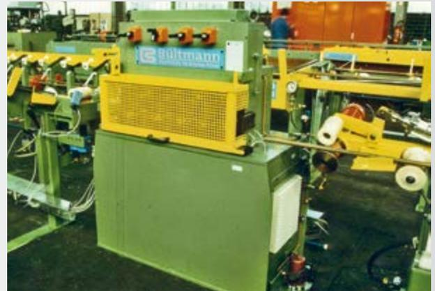
7-Rollen-Profilrichtmaschine für Messingstangen und -profile
