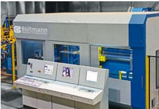
Schälmaschine für Edelstahlstangen bis zu 80 mm
