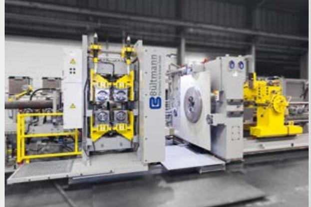
Schälmaschine für hochfeste Stahlstangen
