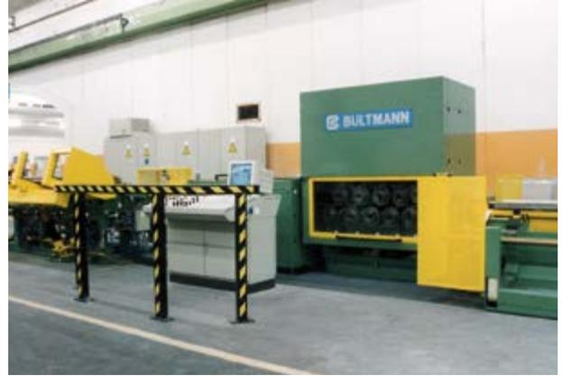
2 x 10-Rollen-Richtmaschine für Messingstangen
