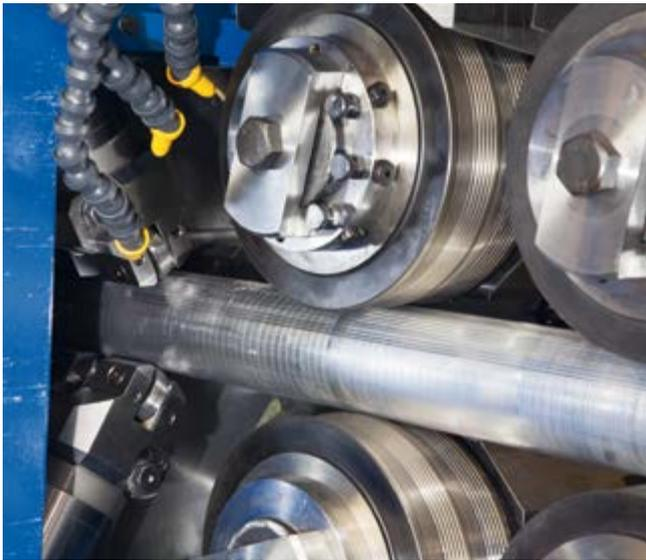
Die in der Regel als Halbzeug für Automotive-Anwendungen eingesetzten Aluminiumstangen werden mit höchster Oberflächengüte geschält. Auch das Zu- und Abführhandling, inkl. Verpackung, arbeitet vollautomatisch, was minimalsten Personaleinsatz ermöglicht.
