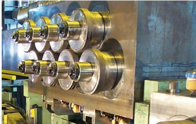
2 x 8-Rollen-Richtmaschine für Stahlstangen und Flachmaterial
