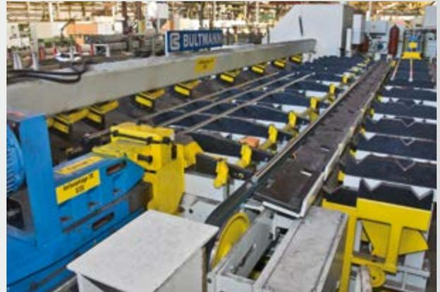
Fasanlage für Edelstahlstangen
