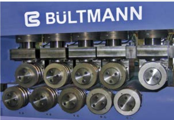
10-Rollen-Vorrichtmaschine für Edelstahlstangen
