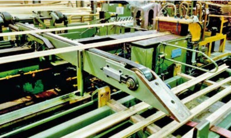
Reckanlage mit Entdrallkopf für Messingstangen und -profile
