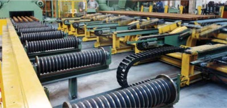
Beschickung vor einer Strahlanlage für Vierkant- und Sechskantstangen sowie Flachmaterial
