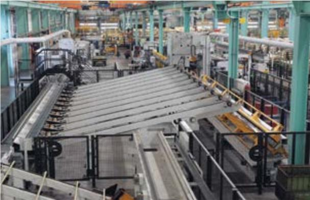
**Stangenproduktionslinie für zylindrische Messingstangen und -profile**
