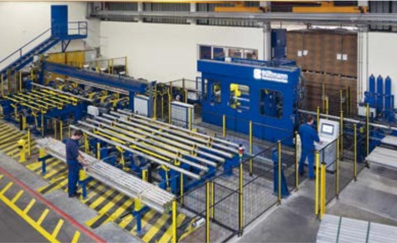
Höchste Präzision und größtmöglicher Durchsatz sind Eigenschaften dieser speziell zum Schälen für Aluminiumstangen entwickelten Schälmaschinen.
