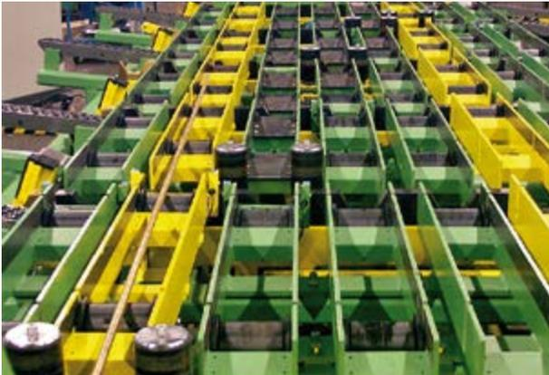
Fasanlage für Vierkant-, Sechskant- und Rundstangen aus Messing
