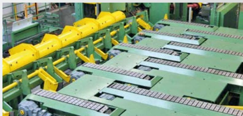
Einlauf und Auslauf für 2-Walzen-Richtmaschine
