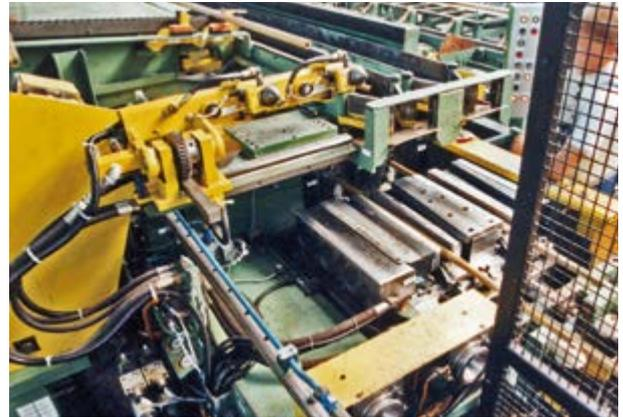
2-fach-Einschubvorrichtung in einer 2-fach-Stangen- und Profildrehmaschine für Messingstangen
