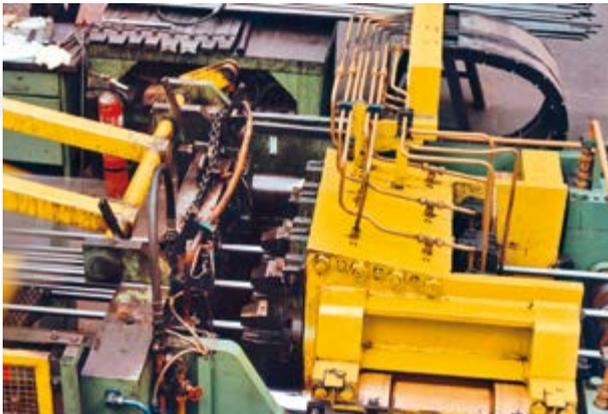
3-fach-Einschubvorrichtung für Rund-, Sechskant- und Vierkantstangen sowie Flachmaterial aus Stahl; kein Backenwechsel bei Dimensionswechsel erforderlich
