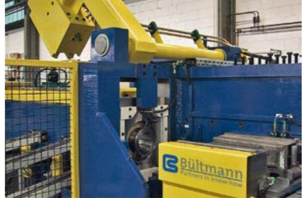
1-fach-Stangenziehmaschine für Supraleitermaterial mit
