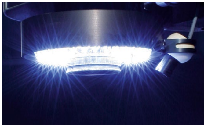
56 LED'er, der kan tændes og dæmpes fleksibelt, til optimal oplysning af emnet.
