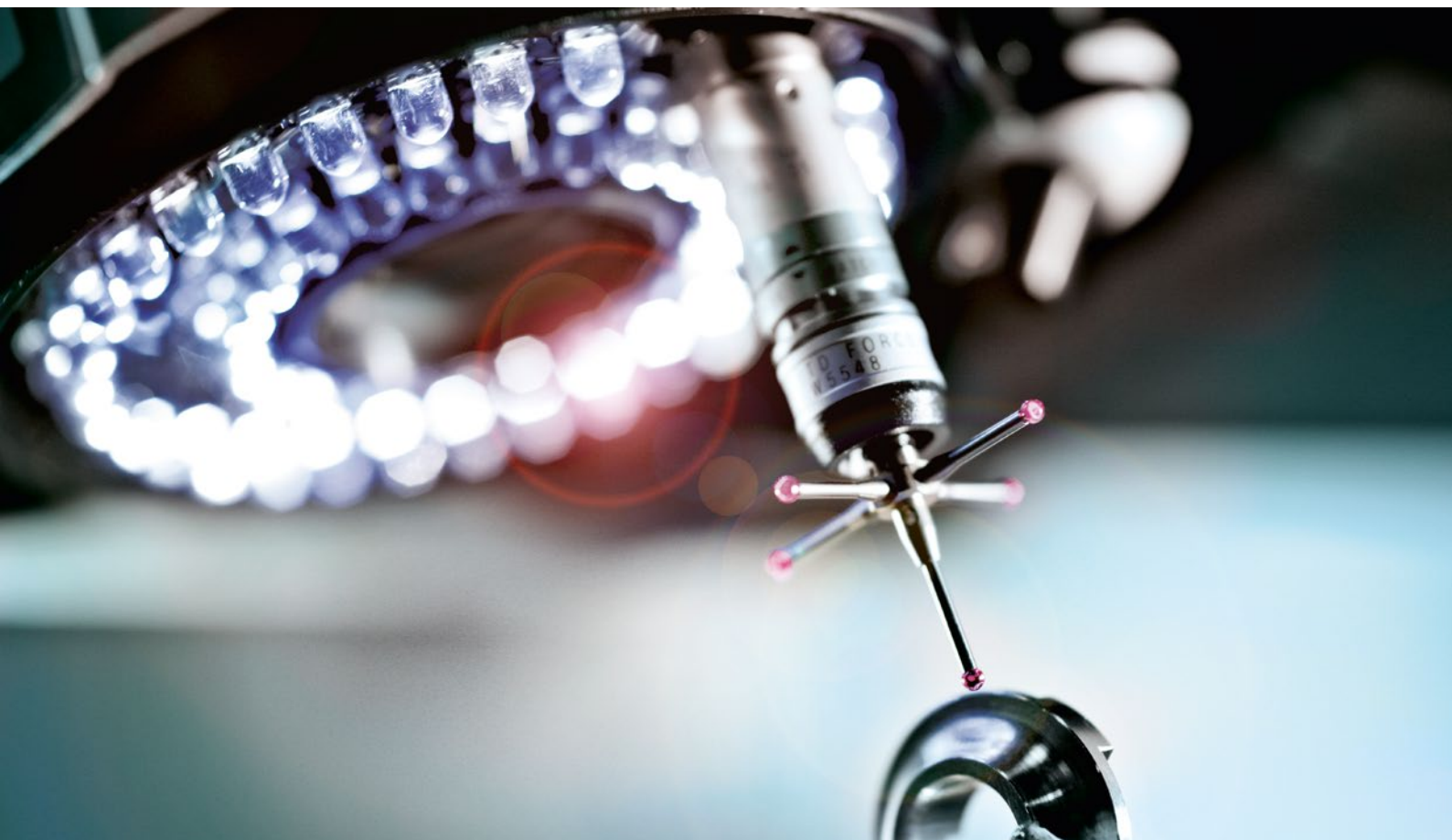
Enten med motorstyret zoomobjektiv og taktilt målesystem TP20
