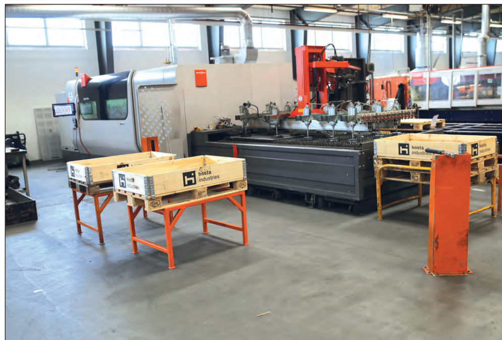
Den seneste Bystronic-investering er på laserskæresiden, hvor Hosta har købt en ByStar Fiber 10 kiloWatt-maskine.
