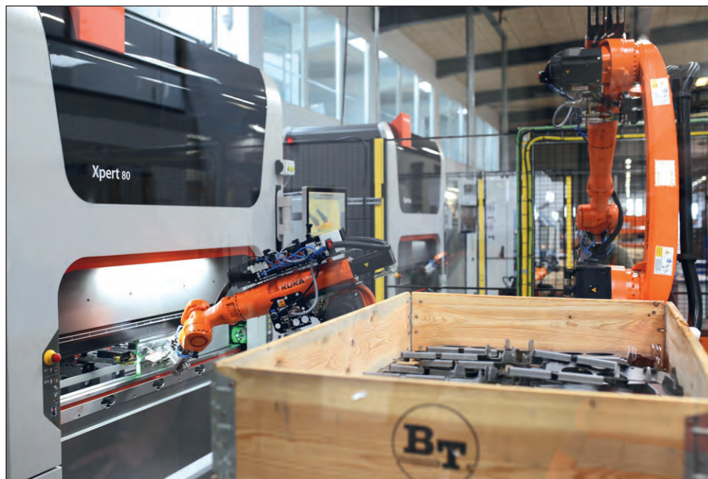
Med to robotter i én celle maksimeres produktiviteten på Xpert 80-kantbukkeren, der er blevet leveret med 11 emner kørt ind på forhånd af automationsleverandøren FH Automation A/S.
