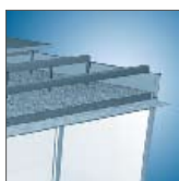
Loft isolering med mineraluld, isolering (40mm tyk)
