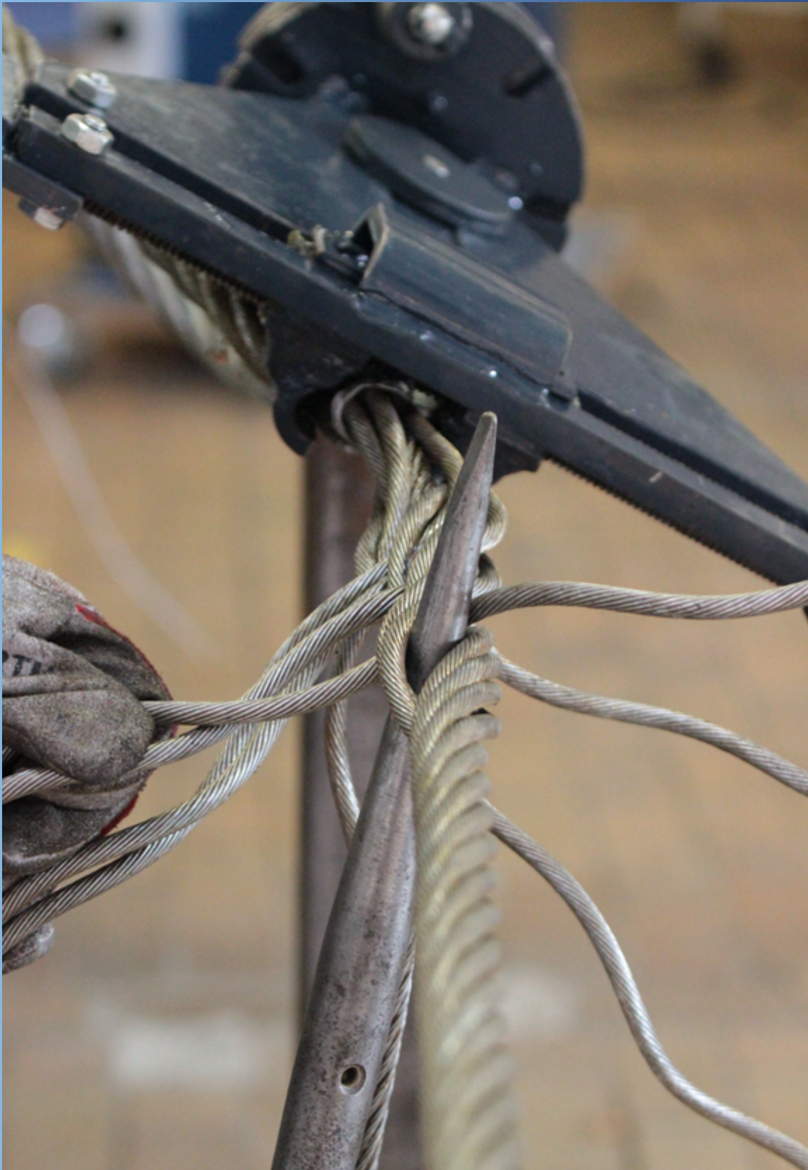
Hand splicing of a steel wire rope / Håndsplejsning af wire
