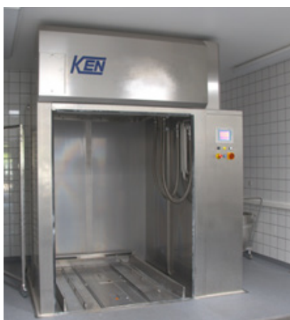
EW 1300 installeret i en pit med direkte tilgang
