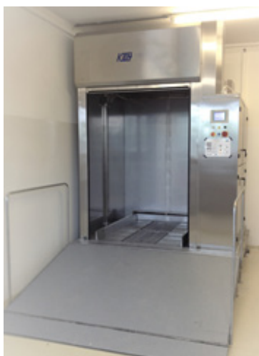
EW 1200 installeret på gulvet med en rampe
