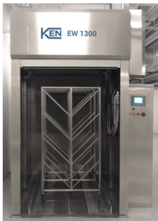
KEN EW 1300 har et ekstra dybt vaskekammer, hvilket gør det muligt at opretholde et højt procesflow.
