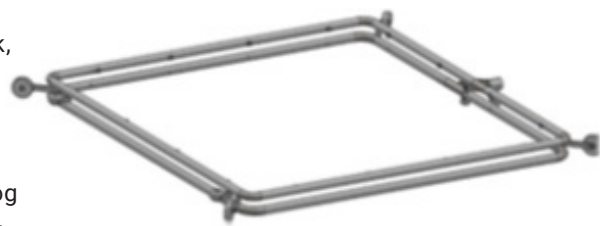
Vaskeramme med to separate systemer (Et til for-skyl/vask og et til slut-skyl)
