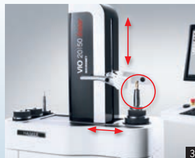
1: Zweite Kamera zum Einstellen der Drehmittellage (optional)/Second camera for presetting the centre of rotation (optional) 2 + 3: Vollautomatischer Achsenantrieb durch modernste Lineartechnologie/Fully automatic axis drive through modern linear technology
