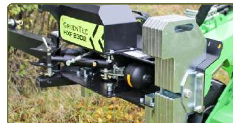
AHS hydraulisk påkörningssäkring med 45° redskapsretur, optimerar arbetet och säkrar maskinen från överbelastning. Motvikter, 55 kg (extrautrustning).
