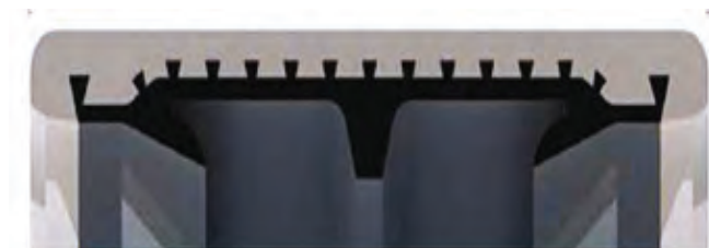
Den indvendige overflade på GRP-koblinger består af EPDM, som sikrer høj tæthed.
