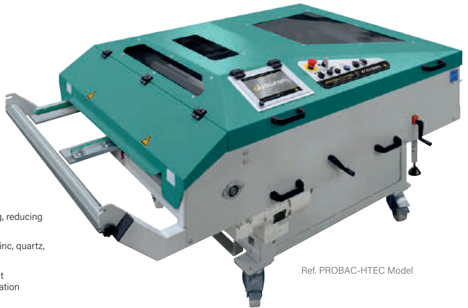
Entry guide on «roller slide» to avoid marking the sheets
