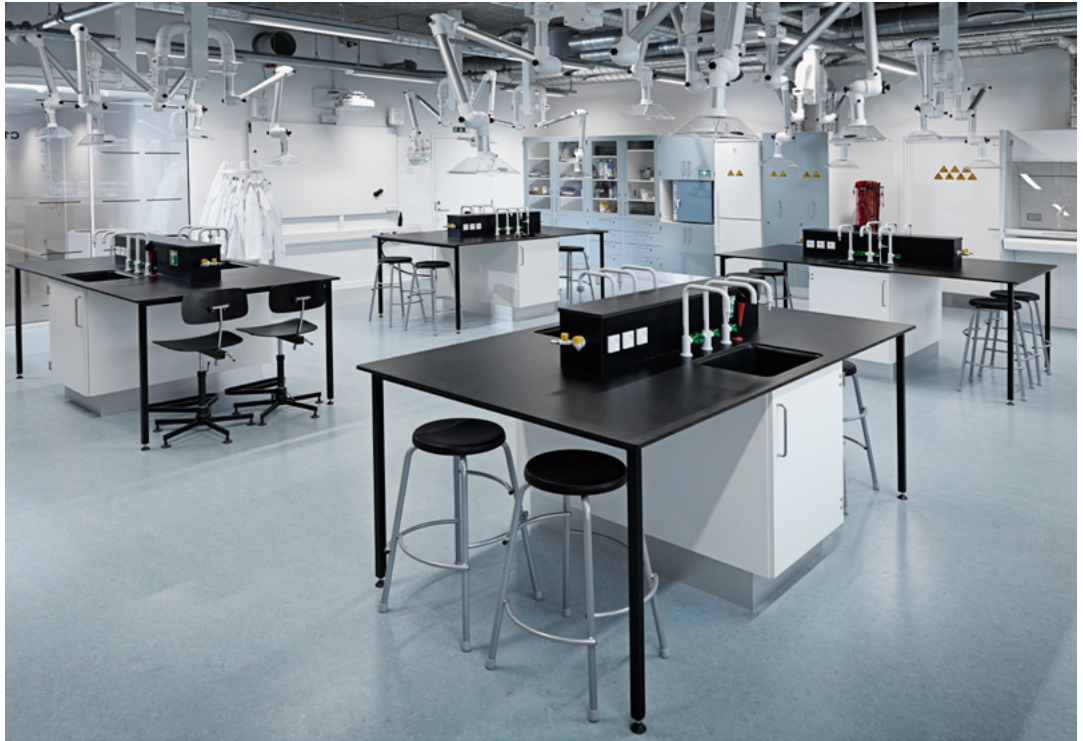
ARBEJDSSTATIONER til forsøg udstyret med el, gashaner, vand, punktsugning fra loft samt nødbruser
