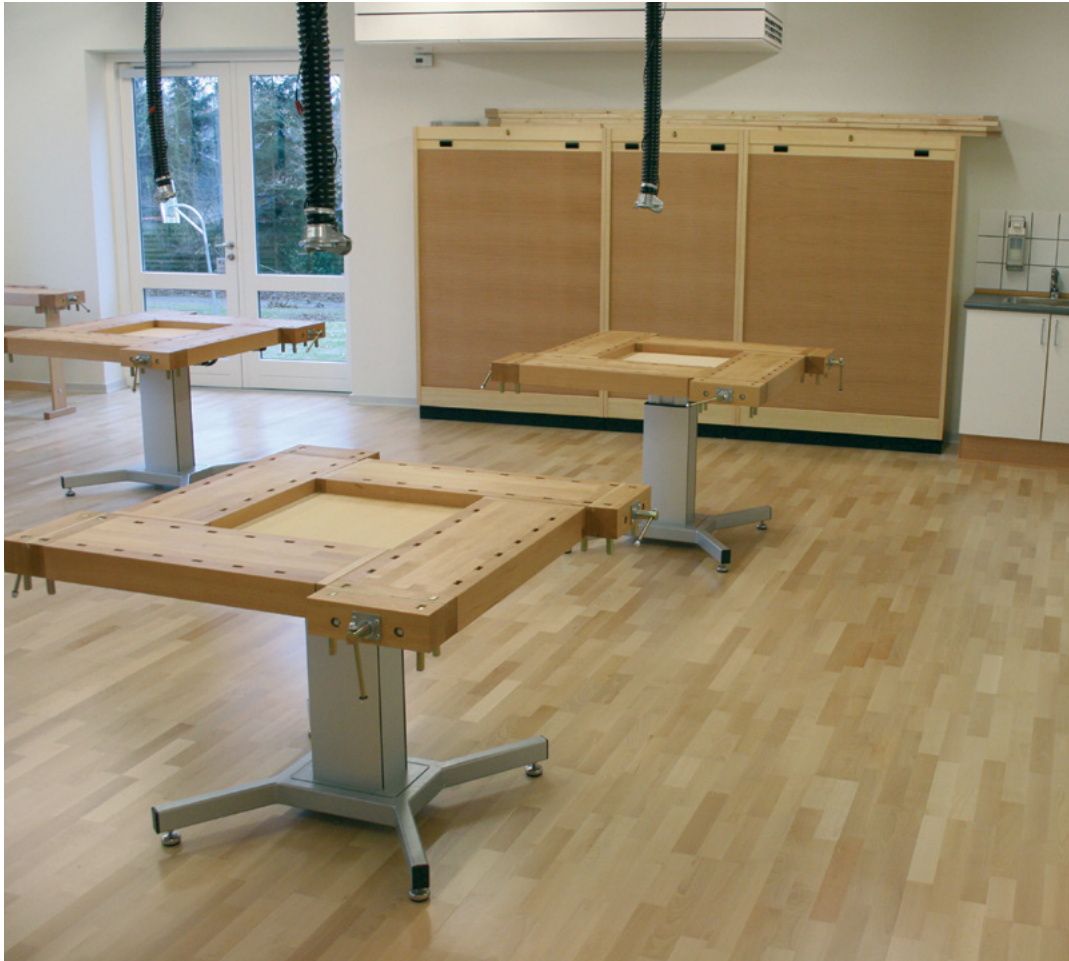
4-Personers sløjdebænk med hæve/sænke funktion. I baggrunden ses værktøjsskabe i fyrretræ
