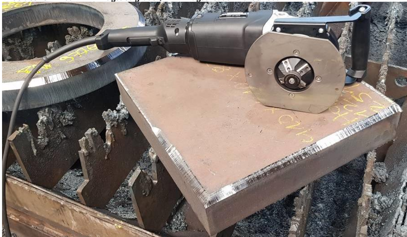
Bilde viser SMA 60 BER – Fuget 60 grader, 14mm fugebredde i Hardox 500
