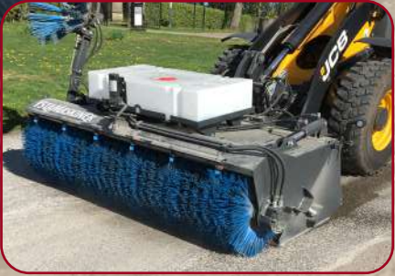
Sopskopa SS-250 med monterad sidoborste och vattensystem
