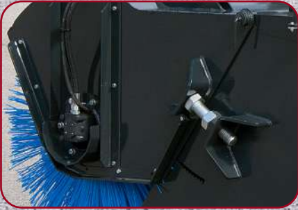
Borstrotorn justeras enkelt med en stor bult med kontramutter
