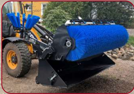
Sopskopa töms genom att lyfta upp borstrotorn och sen tippa skopan
