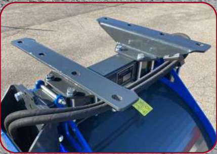
Möjlighet att bulta på valbart fäste, t.ex. grind
