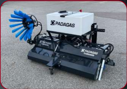
Sopvals SVF-180HB med monterad sidoborste och vattensystem
