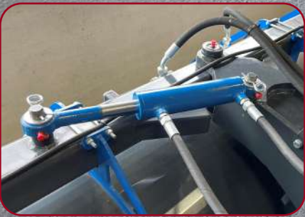
Hydraulisk justering av borstvinkel (standard), styrs via elektrisk 6/2-ventil
