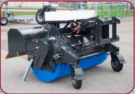
Stabila runtomsvängande massiva stödhjul och uppfälld uppsamlingsbox
