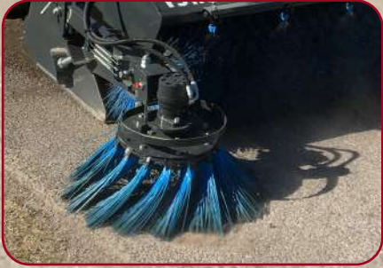
Sidoborste som kan mixas med stål- och nylonborst
