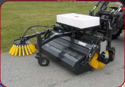
Sopvals SV-210HB med monterat vattensystem och sidoborste
