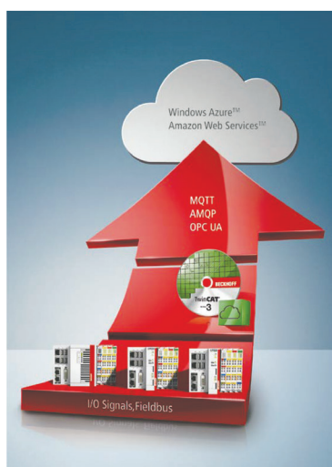
Dataopsamlingen er baseret på Beckhoffs nyeste automatiseringsteknologi - Embedded Controller CX9000 serie, M-Bus terminal og TwinCAT – IoT, med OPC-UA Cloud/Big Data.
