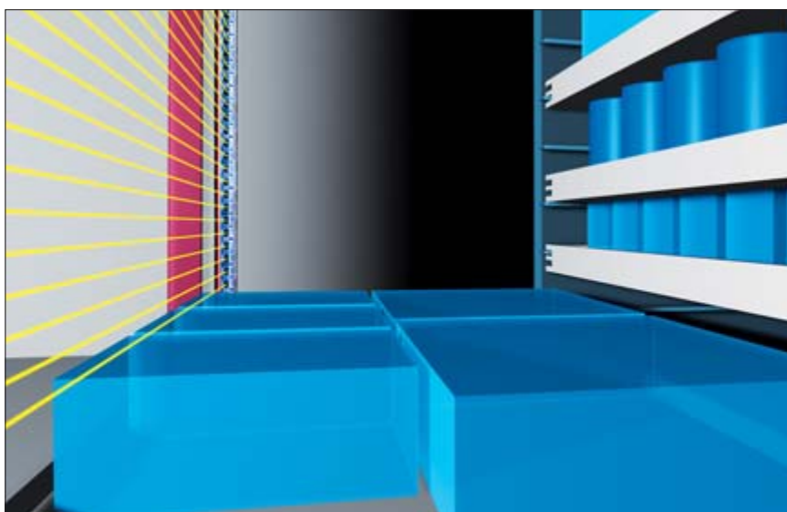
De lagrede varer måles ved arbejdsåbningen af højdesensorerne
