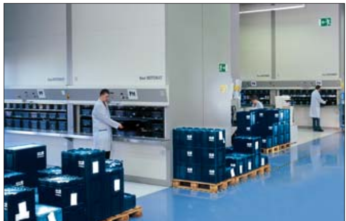
Antistatisk opbevaring i Hänel Rotomat® industripaternostre lige ved siden af produktionslinjen
