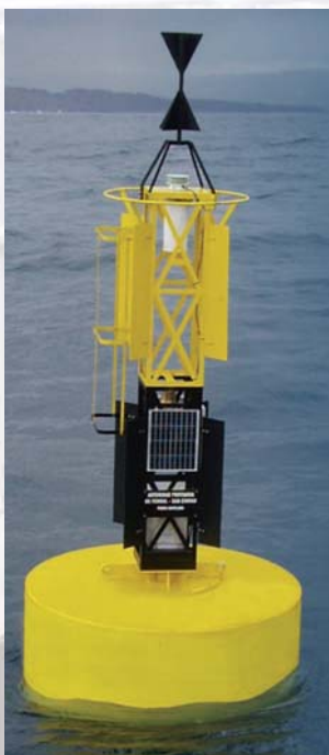
UV-beständig navigationsbøje med PUR-overflade og skumkerne af lukkede celler, så den ikke tager vand ind og synker efter skade
