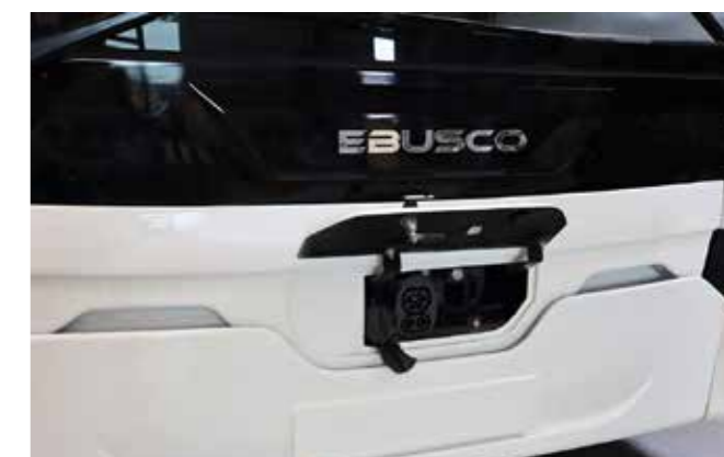
Phoenix Contacts universelle køretøjsladeinlet kan nemt integreres i køretøjer og tilbyder mange fordele
