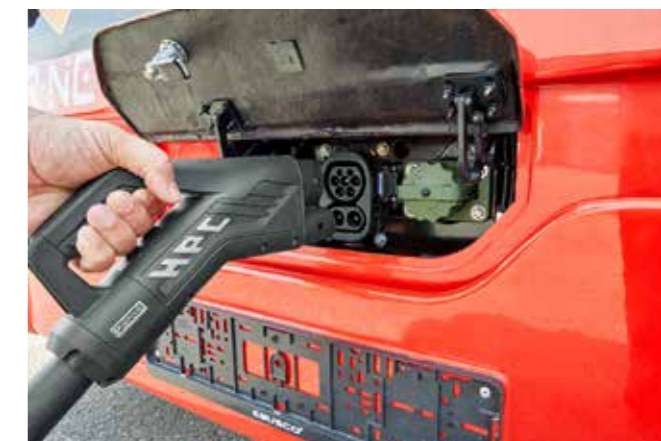
Med Phoenix Contacts køretøjsladeinlet kan et konstant ladeeffekt-niveau på 250 kW og midlertidige højere niveauer op til 500 kW opnås; det muliggøres af de høje ladeeffekter, der er nødvendige til brugskøretøjer
