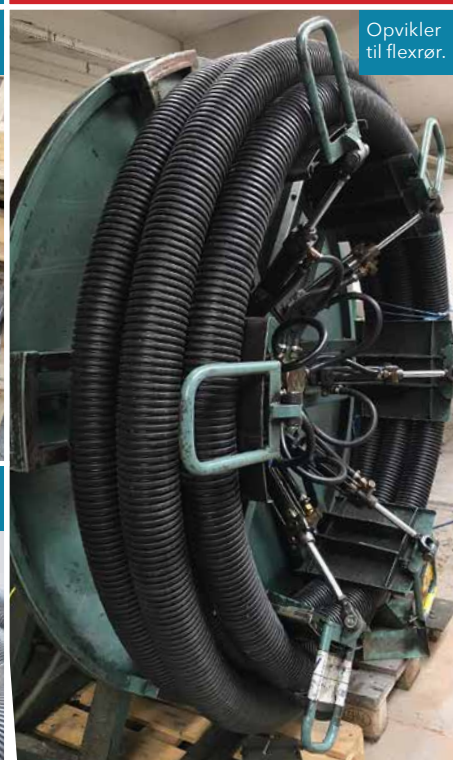
Højtemperaturrør med 40 mm mineraluld.
