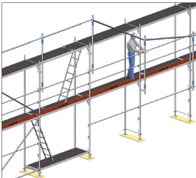
Fig. 26: Detalje for anvendelsen af MSG ved stilladsmontage
