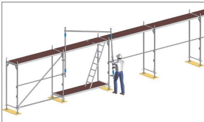
Fig. 25: Montage af MSG i opstigningsfeltet
