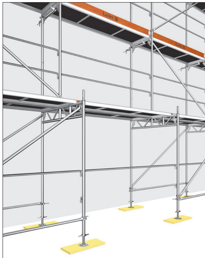
Fig. 105: Indbygning af gennemgangsramme
