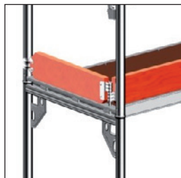
Fig. 35: Indhængning af kantbræt
