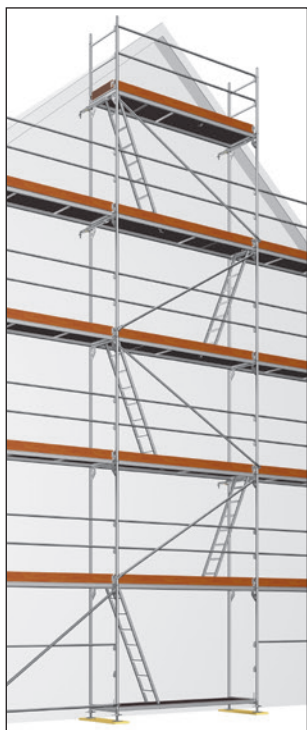
Fig. 62: Opgang med stilladssstiger
