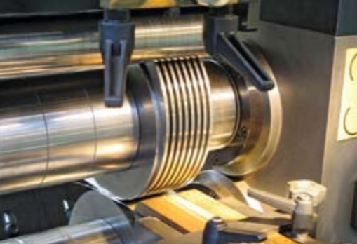
Schneiden mit Exzenter-Stahlauswerferringen Cutting by using eccentric steel stripper rings
