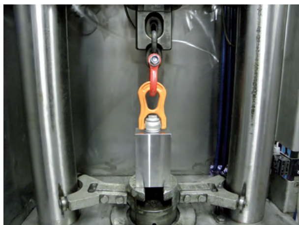
Test i pewag laboratorium inkl. træthedstest med minimum 20.000 cyklus. Testing in pewag laboratory incl. fatigue test with minimum 20.000 cycles.
