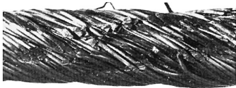
Mekanisk skade forårsaget af at wiren løber over skarpe kanter under belastning.
