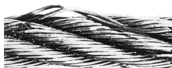
Trådbrud ved kontakt mellem kordeler eller mod kerne som følge af at kernen ikke giver kordelerne tilstrækkelig støtte. Må ikke forveksles med ydre trådbrud.
