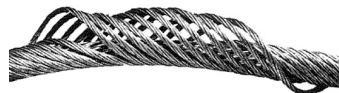
Rotationsfri stålwire med optvungne kordeler som følge af ujævne vridningspåvirkninger. Typisk skade som opstår ved endeindfæstning på flerparts kranwire.
