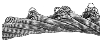
Udbøjning af kordelkerne som følge af vridningspåvirkninger forårsaget af arbejde i kulde (chokbelastning).
