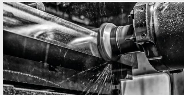
Edge milling of cast iron table
