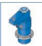
**Überall dort, wo Spannpunkte oder Spannstellen in Vorrichtungen frei sein müssen, um Werkstücke leichter be- und entladen zu können, kommen diese doppeltwirkenden Schwenkspanner zum Einsatz. Zwei Ausführungen stehen zur Verfügung. Bei beiden Ausführungen sorgt die extrem starke Kurvenführung für erhöhte Einsatzdauer. Die nitrierten Gehäuse garantieren eine verschleißfreie Oberfläche.**
