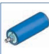
**Die AHP-Kurzhubzylinder sind über die ganze Zylinderlänge mit einem Außengewinde versehen. Der Zylinder wird in die Vorrichtung eingeschraubt bzw. angeflanscht. Beide Hydraulikanschlüsse sind axial am Zylinderboden angeordnet. In dieser Variante ist er ein besonders einbaufreundliches Konstruktionselement. Serienmäßig mit VITON-Dichtung ausgerüstet. Ab Lager lieferbar.**
