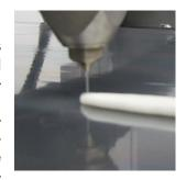
Die Heißleimstreifen- und Punkte sind größer und füllen besser aus. Dies ist besonders vorteilhaft, wenn der Leim als Füll- und Dichtmittel verwendet wird und dort wo auf die Flexibilität der Leimfuge großen Wert gelegt wird, wie in der Textilindustrie.
