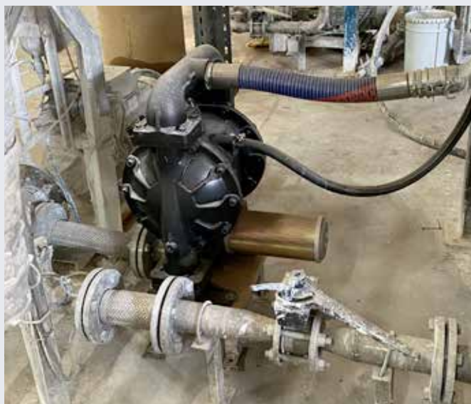
Hög sughöjd minskar pumpens kapacitet.
