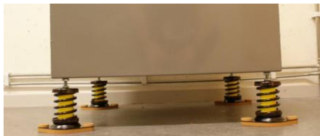
Sylomer® fotplatta ska monteras så att foten står i centrifugens riktning
