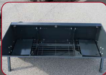
Öppningsbara skyddsgaller och spidarregleringsplåtar
