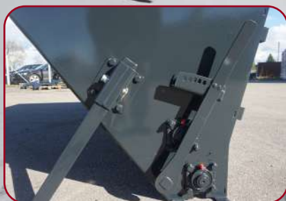
Stöbren och reglering av utmatning
