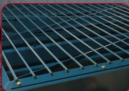
Galler som förhindrar klumpar vid påfyllning
