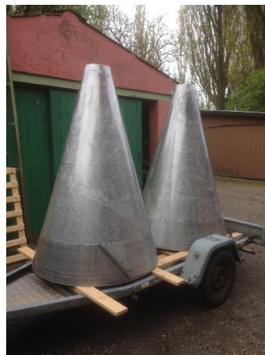
Billede 8: Valsning af rustfrie kegler - Novo Nordisk.
