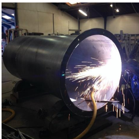
Billede 1: Valsning og svejsning af trykbeholder.
