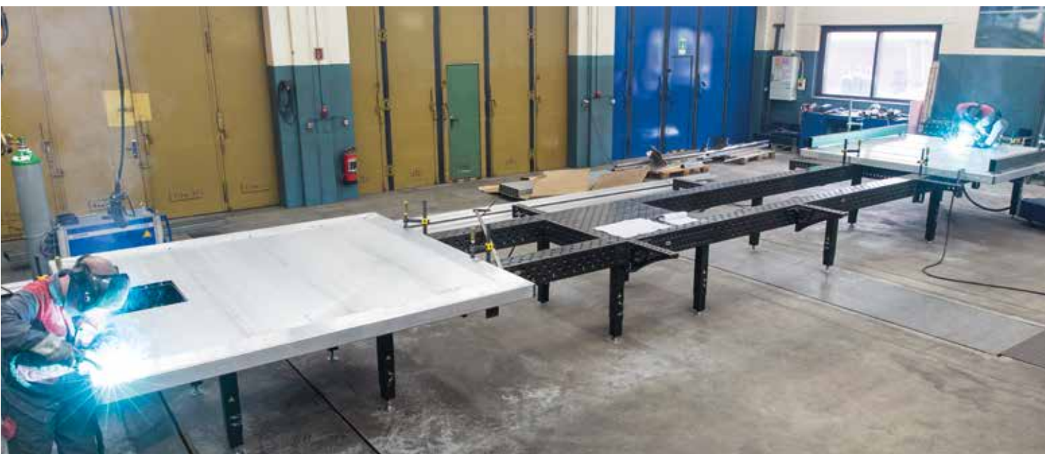
Komponentene til ei bakluke blir sveiset.
