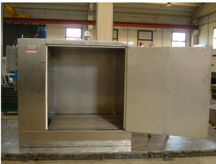
(2/2) Varmeovn til 4 tromler, op til 150°C, drives af damp, ATEX godkendt, med opsamlingskar, AISI304 rustfri stål konstruktion.
