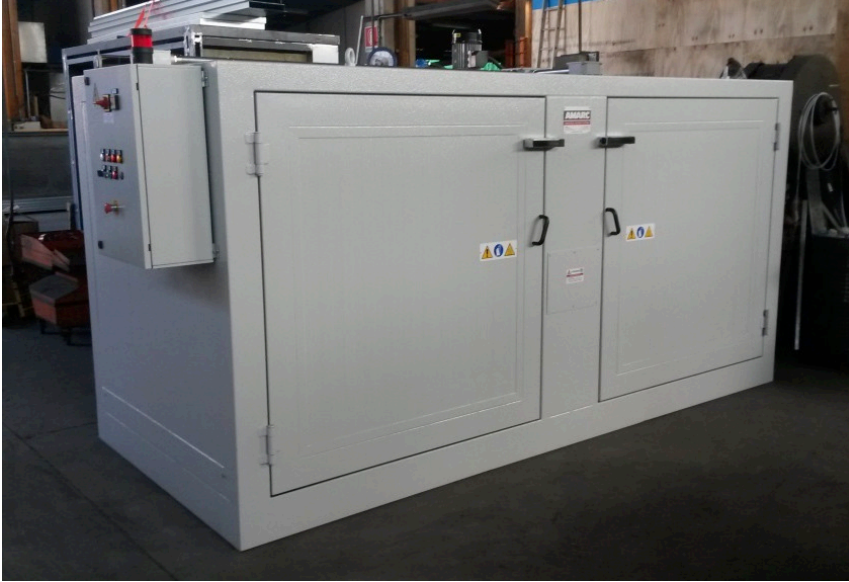
Horisontal varmeovn til 8 tromler,. Temperatur op til 100°C, drevet af el, med opsamlingskar.
