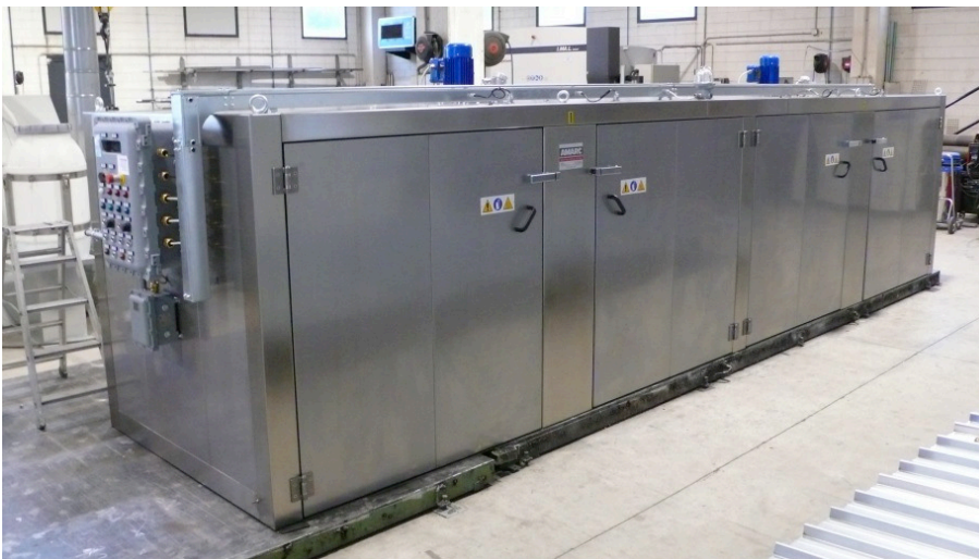
(1/2) Forside Horizontal varmeovn til 16 tromler, opdelt i 2 kamre til hver 8 tromler. Drevet af damp med temperatur op til 150°C. ATEX godkendt og AISI304 Rustfri stål konstruktion.
