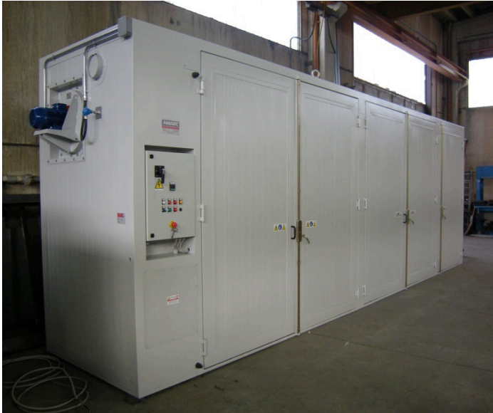
Varmeovn til 40 tromler, op til 90°C, elektrisk drevet.
