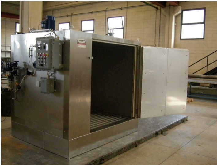
(1/2) Varmeovn til 4 tromler, op til 150°C, drives af damp, ATEX godkendt, med opsamlingskar, AISI304 rustfri stål konstruktion.
