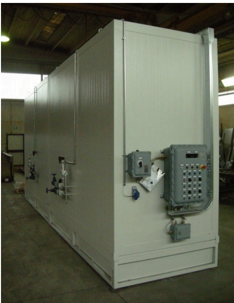
(2\2) BAGSIDEN Horizontal varmeovn til 32 tromler, opdelt i 2 separate kamre til hver 16 tromler. Temperatur op til 150°C, drevet af både el og damp. ATEX godkendt og med opsamlingskar.
