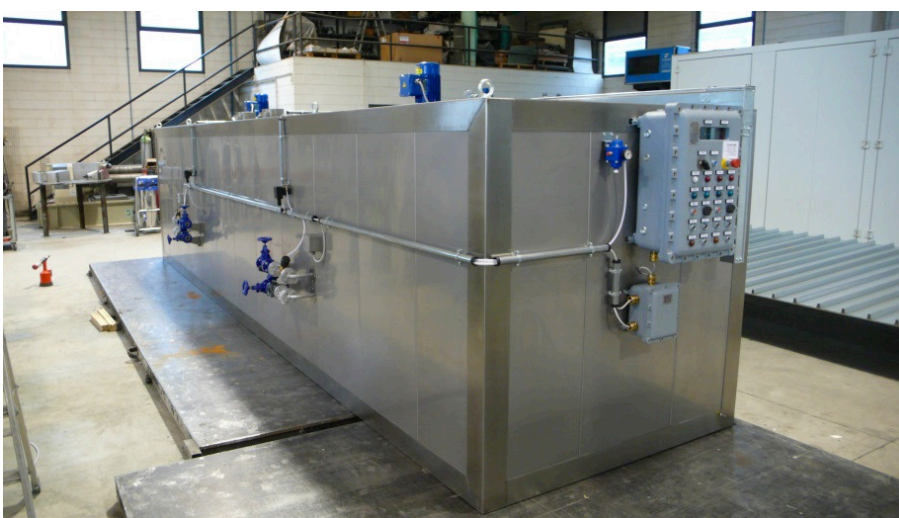
(2/2) Bagside Horizontal varmeovn til 16 tromler, opdelt i 2 kamre til hver 8 tromler. Drevet af damp med temperatur op til 150°C. ATEX godkendt og AISI304 Rustfri stål konstruktion.
