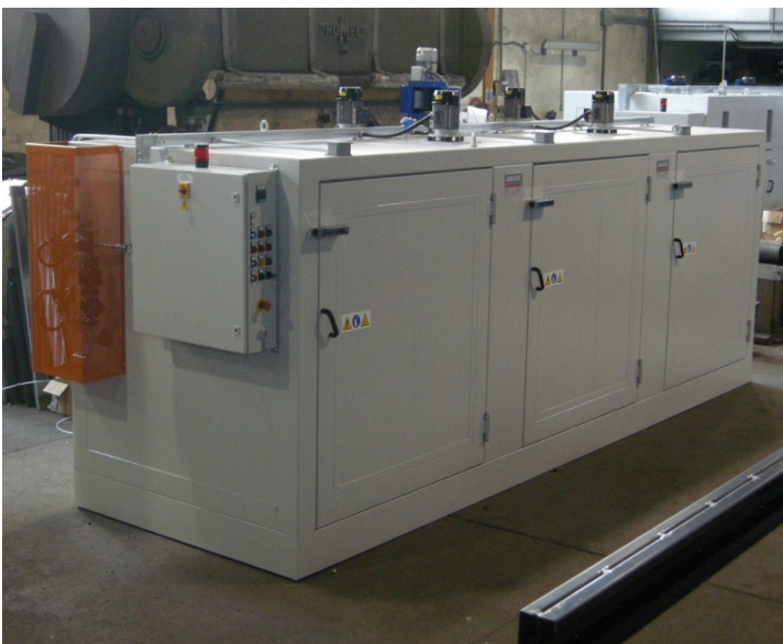
Horisontal varmeovn til 12 tromler. Drevet af damp, med temperatur op til 100°C. Med opsamlingskar og udsugningssystem.
