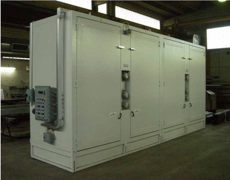
(1\2) FRONTEN Horizontal varmeovn til 32 tromler, opdelt i 2 separate kamre til hver 16 tromler. Temperatur op til 150°C, drevet af både el og damp. ATEX godkendt og med opsamlingskar.
