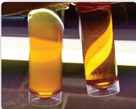
Billedet viser resultatet af en test, hvor brændstoffet blev filtreret med Separ LKF. Røret til venstre indeholder dieselolie forurenet med vand. I røret til højre har den samme dieselolie passeret igennem filteret en gang.
