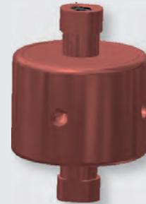
Die Kombination von körperschalldämmenden Abspannelementen und Spannschloss mit Rechts- bzw. Linksgewinde ermöglicht außer der Platzersparnis durch kurze Einbaulänge auch wesentliche Montagevereinfachung und Zeitersparnis bei Ausrichte- und Anpassarbeiten. Die Hauptbeanspruchung ist in Zugrichtung.
