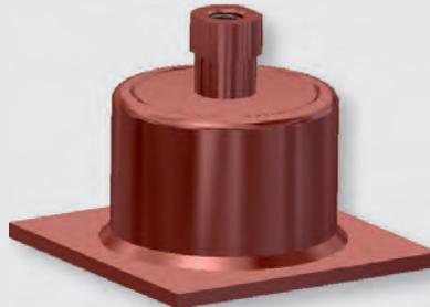
Dieses Spezialelement mit Grundplatte zum Anschweißen oder Verschrauben zeichnet sich durch Druck-, Zug- und angulare Kraftaufnahme aus. Die Abspannung folgt formschlüssig spielfreien Bewegungen und Wärmedehnungen des Bauteils. Das spätere Nachspannen der Traverse ist durch Verdrehen des Anslussteiles möglich.
