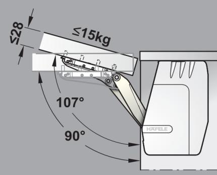
Öffnungswinkel standardmäßig 107°, auf 90° begrenzbare. Frontgewicht bis 15 kg bei 600 mm hohen Fronten. Klappendicke bis 28 mm ohne Kollision mit überstehenden Griff- oder Kranzprofilen (bei 90° Öffnungswinkel).
