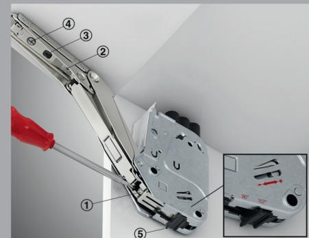
Die Haltekraft (1) und das Fugenbild (2–4) lassen sich bequem von vorne einstellen. Bei Free flap 3.15 kann der Öffnungswinkel direkt am Beschlag von 107° auf 90° reduziert werden (5).
