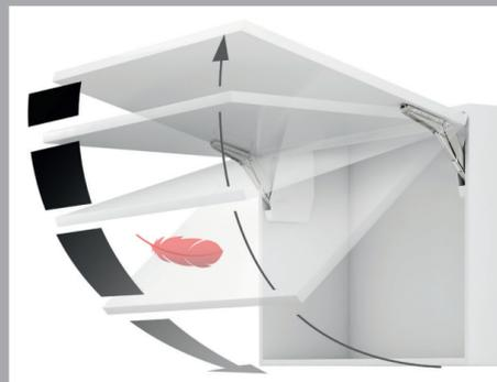
Mit Free flap lässt sich selbst eine große Klappe mühelos öffnen. Dabei hält sie in jeder Stellung (Multi-Positionsstopp), der Schließvorgang erfolgt fließend weich.
