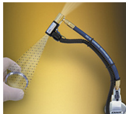
Ion dysen renser støv fra et glaslinse før installation på en måler.
