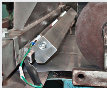
Statisk elektricitet er neutraliseret på filmoverfladen for at fjerne støvtiltrækning.
