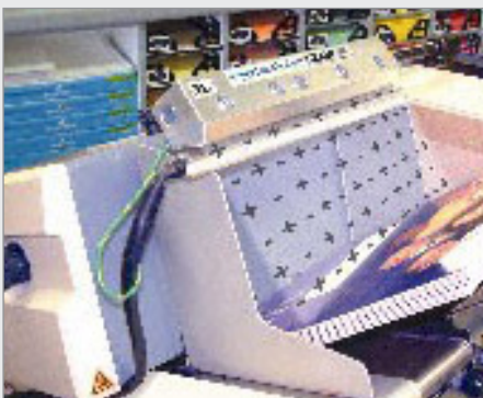
Super ion luftkniv eliminerer fastklæbning, samtidig med at udskriftskvaliteten forbedres på en inkjet-adressemaskine.
