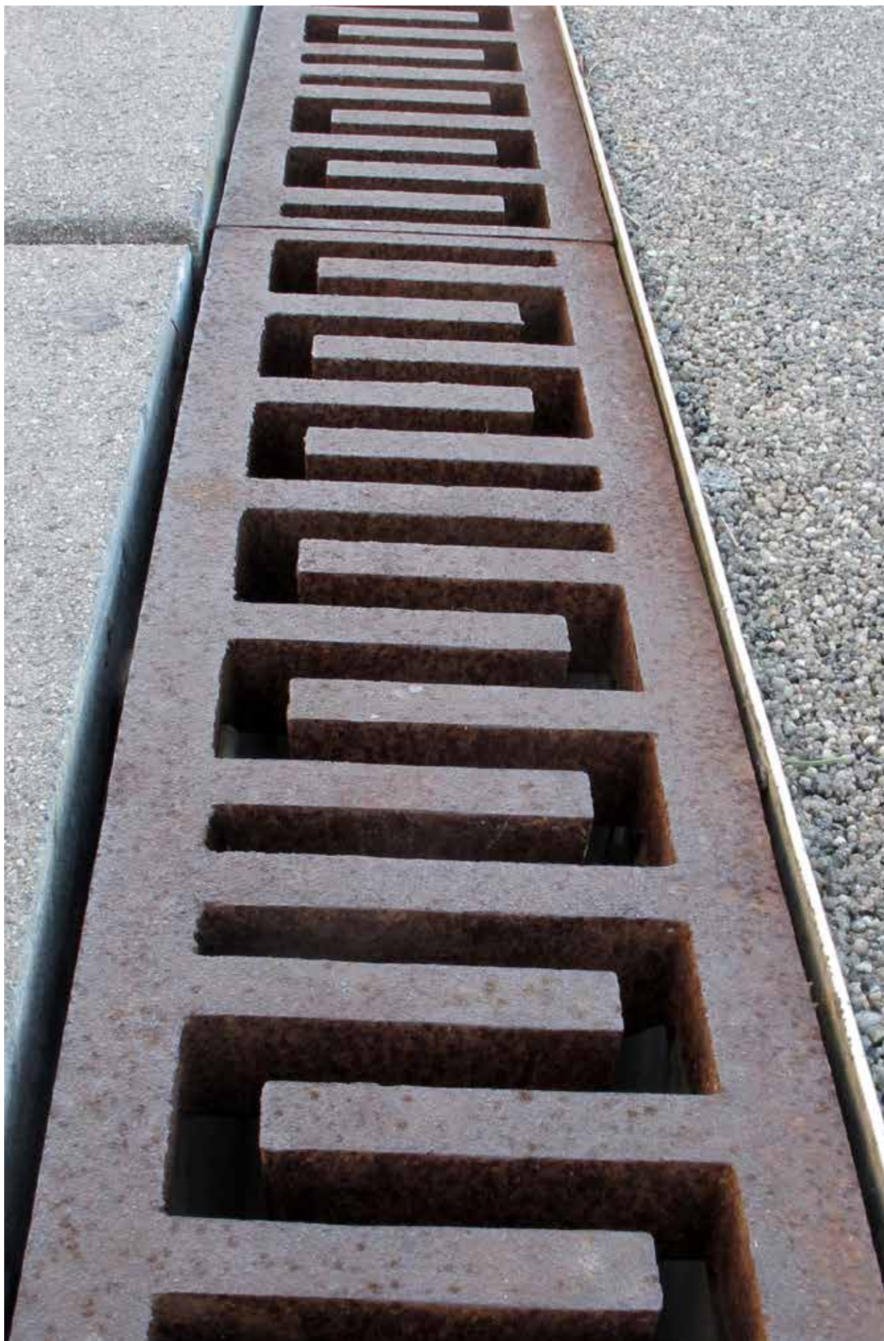
Stålkarmen er til lægning af asfalt. Den er fremstillet i rustfast stål og har en ekstra kant, som går op omkring risten, så asfalten kan lægges helt op til. Således ligger risten fri og kan tages op, uden at asfaltbelægningen ødelægges.
