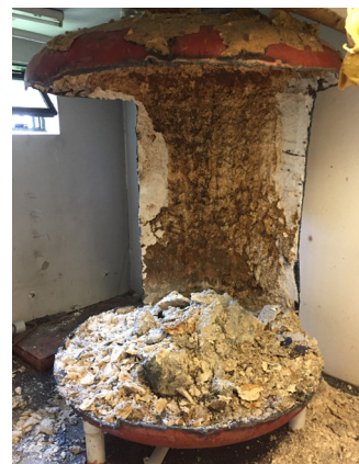
Den gamle varmtvandsbeholder i Kagsgården var kalket fuldstændig til indvendig. Det sker ikke med det nye anlæg, hvor der er tilkoblet et blødgøringsanlæg.
