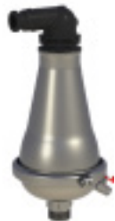
Serie 701/75 Kombinationsudluftningsventil Udluftningsareal: Automatisk: 12 mm 2 Kinetisk: 804 mm 2 Forstærket nylon Indløbsflange eller 2 1/3" BSP-gevind DN50-100 PN10
