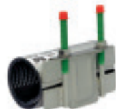
Serie 729/01 Reparationsklamme Enkeltbånd med støtteplade Rustfrit stål AISI 304 eller AISI 316 NBR- eller EPDM-gummi
