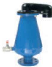
Serie 701/96 Kombinationsudluftningsventil Udluftningsareal: Automatisk: 12 mm 2 Kinetisk: 804 mm 2 Rustfrit stål Indløbsflange eller 2" BSP- gevind DN50-200 PN16
