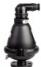
Serie 701/75 Kombinationsudluftningsventil Udluftningsareal: Automatisk: 12 mm 2 Kinetisk: 804 mm 2 Forstærket nylon Indløbsflange eller 2 1/3" BSP-gevind DN50-100 PN10
