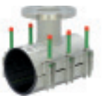
Serie 729/32 Reparationsklamme Dobbeltbånd med flangetilslutning og afstivere Rustfrit stål AISI 304 eller AISI 316 NBR- eller EPDM-gummi
