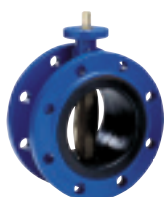
Serie 75/20 Centrisk butterflyventil med fast gummiliner Dobbeltflange, kort Duktiljern Med alle typer aktuatorer
