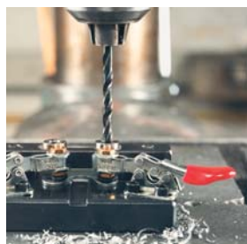
Model 205-U Horizontalspænder anvendt ved borefixtur
