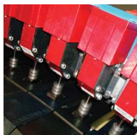
Model 8031 Pneumatiske spændere anvendt i en svejseopstilling
