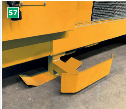
57 Glidesko (ekstraudstyr) Glidesko for lettere lastning og losning af betonbladeanlægget i container (sæt af 4 stk.).
