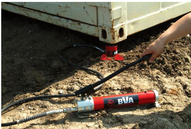
Picture is of a Hydraulic Hand Pump & a Cylinder Billedet er af en Hydraulisk Håndpumpe & en Donkraft
